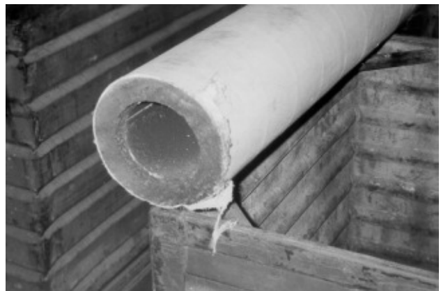
Calorifugeage contenant de l'amiante, photo IST
