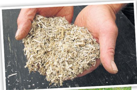
La chènevotte est la partie centrale et moelleuse de la tige de chanvre, obtenue par défibrage mécanique.
