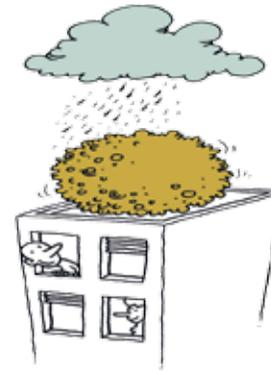
**RÉTENTION** En cas d'orage ou de fortes précipitations, la toiture végétalisée retient l'eau, la filtre et ralentit le débit d'évacuation, ce qui évite une surcharge des réseaux d'eaux claires et participe à la régulation des débits de pointe dans les cours d'eau. Plus l'épaisseur du substrat est importante, meilleure sera la rétention d'eau.
